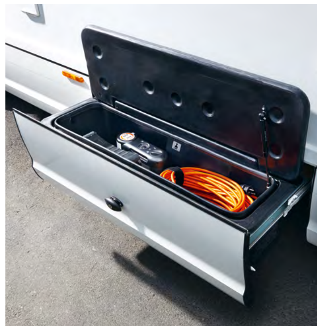
V2092510 Uitschuifbare opberglade in zijskirt langs bestuurderszijde
