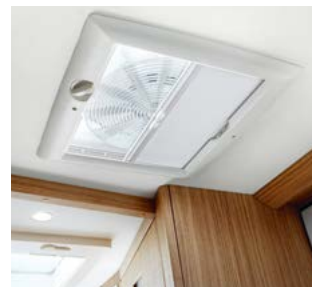
V3009011 Ventilator boven keuken
